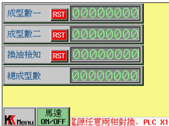
當合模壓力實際值大於設定值後，所有的計數器便會自動加 1，成型數一及成型數二可由使用者自行定義使用，換油檢知為當合模次數超過 180000 時，會有跑馬燈通知換油。而總成型數為此模造機生產總成型數，無法更改。
